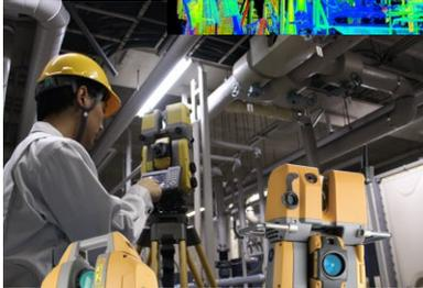
3Dレーザー scanner レーザースキャナートータルステーション
