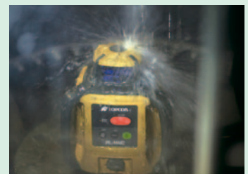
防水テスト：JIS 保護等級 6 級 全方向からの強力なジェット噴流水に耐える
