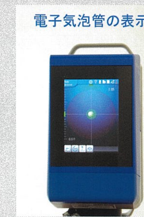
電子気泡管の表示 5.7 インチタッチスクリーン
