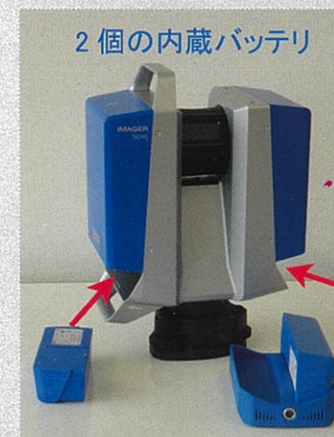
2 個の内蔵バッテリー 航空機搭載基準をクリア ホットスワップ式
