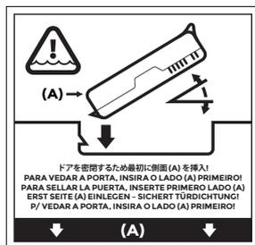
バッテリーの前端にある黒いタブが上になり、ドアラッチと向い合わせになるように、バッテリーを持ちます（このタブは、バッテリーを引き抜くときに役立ちます）。最初に後端を配置し、2つのバッテリーキャッチの下にそっと押し込みます。所定の位置にくるまで、前端を下に回転させます。
