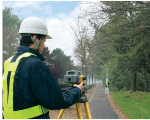
レベルは水準測量から土木、建築、計測と様々な分野において、高さを正確に測る機材として広く利用されています。レベルをデジタル化することで、簡便で間違えの無い作業が可能となりました。これまでのような観測者によるレベルスタッフの読み取りが不要となり、多大な作業効率の低下につながる読み間違いを防止できます。また、精度のバラツキ要因となる個々の観測者の読み取り誤差を低減させ、安定した精度のデータを得ることができます。
