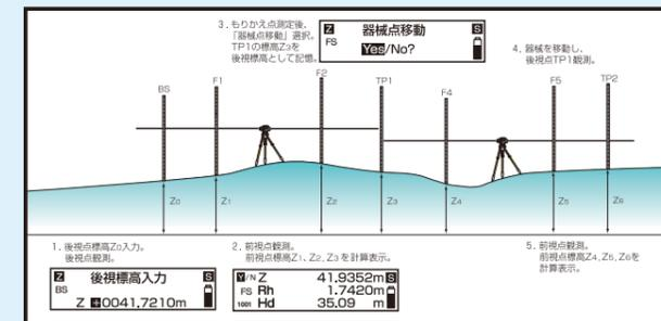
「標高測定機能」で後視点の標高を入力すれば、前視点の標高を自動計算表示します。また、「器械点移動」を選択すれば、もりかえ点の標高を後視点標高として記憶し、連続標高測定ができます。
