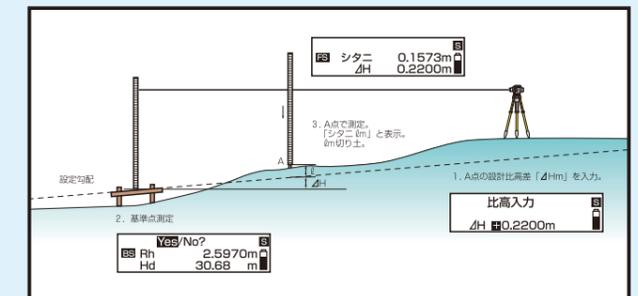
「比高測定機能」で基準点との比高差を入力すれば、勾配設定が簡単に行えます。0.1mmまたは1mm単位で切り土・盛り土の測定ができます。
