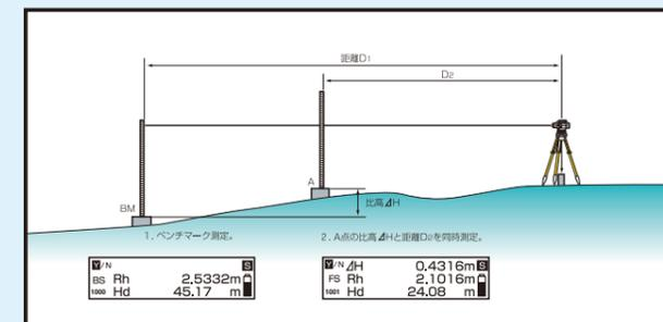
「比高測定機能」を使えば、後視点との高低差を計算表示します。0.1mmまたは1mm単位で測定できます。
