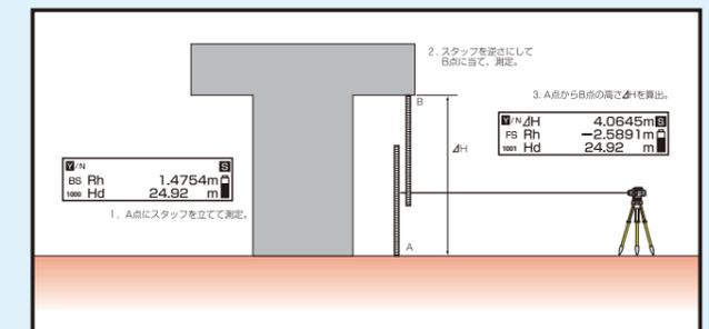
「比高測定機能」を選択し、測点の真下と天井にスタッフを当てて測定すると、自動的に測点の高さを表示します。さらに、「標高測定機能」を使って地面の標高を入力すれば、測点の標高が分かります。
